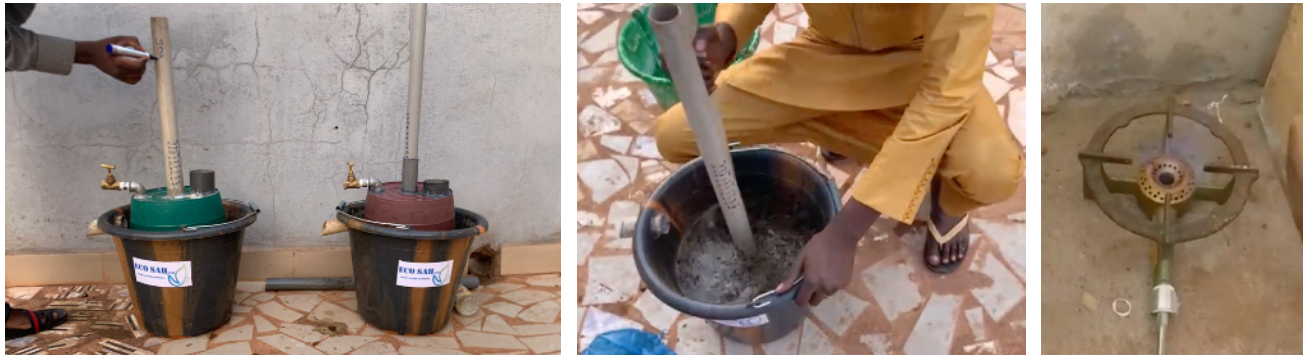
Les modèles de petits digesteurs Eco-Sah utilisent de la bouse de vache pour produire le biogaz qui alimente un réchaud.
